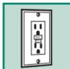
Un interruptor de circuito de corriente de pérdida a tierra (GFCI) está diseñado para tropezar o interrumpir la corriente eléctrica rápidamente para evitar el choque o la electrocución.
